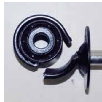
Testovanie predčasne ukončené: Tlmič pruženia KYB po 600 903 záťažových cykloch
