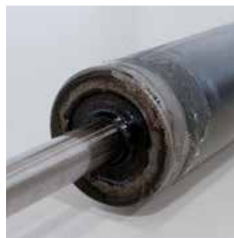
Testovanie predčasne ukončené: Tlmič pruženia ZF Sachs po 544 175 záťažových cykloch
