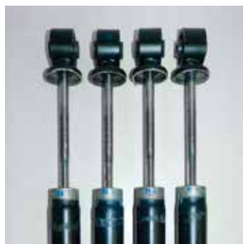
Volkswagen Originálny tlmič pruženia po 1 milióné záťažových cyklov
