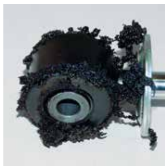
Tlmič pruženia AL-KO po 1 milióné záťažových cyklov
