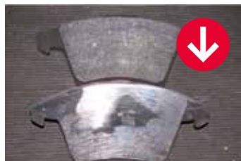
Predčasné opotrebenie: Brzdové obloženia TRW po 1388 brzdzeniach
