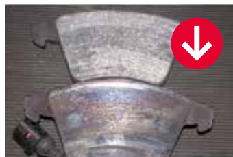
Predčasné opotrebenie: Brzdové obloženia ATE po 1357 brzdzeniach
