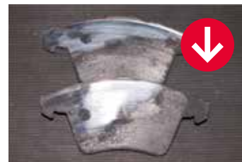
Predčasné opotrebenie: Brzdové obloženia Mintex po 1198 brzdzeniach
